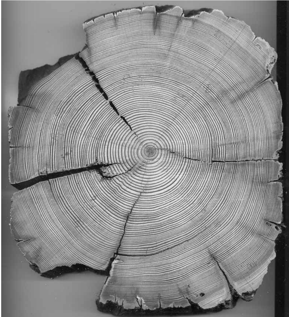
Photo 6 : section de poutre de plancher de la maison de la ferme Les Ramés (bois 27, mélèze). Au centre, la moelle ; la couronne périphérique plus claire correspond à l'aubier ; entre les deux, le bois parfait, appelé duramen.
