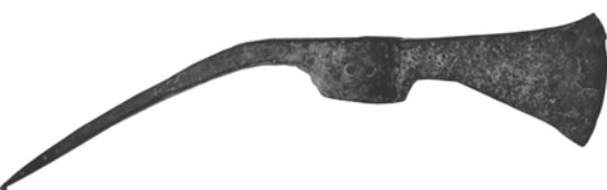
La « pétugue » L 46,5cm lg 5,3 cm Forgée, réparation chaud en deux points au niveau de l'œil. ©E.P.R
